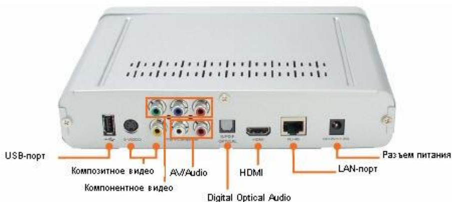
Выполнив следующие инструкции, вы легко и быстро установите D-Link DIB-120. Для подключения D-Link DIB-120 к телевизору можно использовать межблочный AV-Audio кабель 3RCA-3RCA (прилагается), кабель HDMI, S-Video или компонентный видео кабель 3RCA-3RCA. Если у вас есть такая возможность, то D-Link DIB-120 также можно подключить к стерео усилителю через цифровой выходной разъем S/PDIF.
