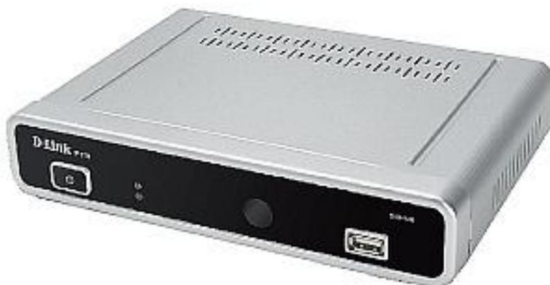
Верхний индикатор горит при включении D-Link DIB-120, в режиме StandBy или при прекращении подачи электропитания он не горит. Нижний индикатор показывает активность по LAN-порту, он моргает при получении и отправке пакетов через сеть. Нижний индикатор работает и в режиме StandBy.
